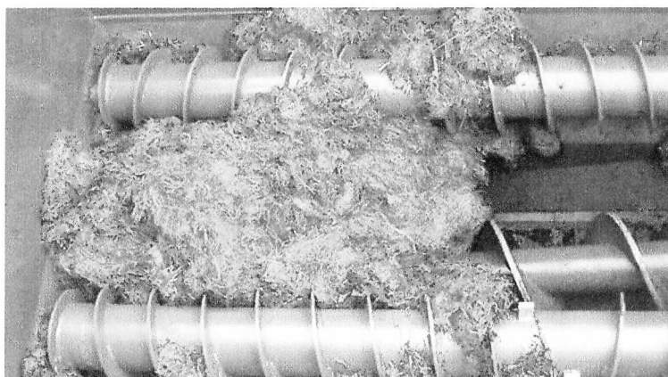
Widok podajnika ślimakowego dozującego substrat i roztrzásacz wewnątrz urządzenia Vielfrass® w wersji Standard Źródło: www.agrikomp.pl
