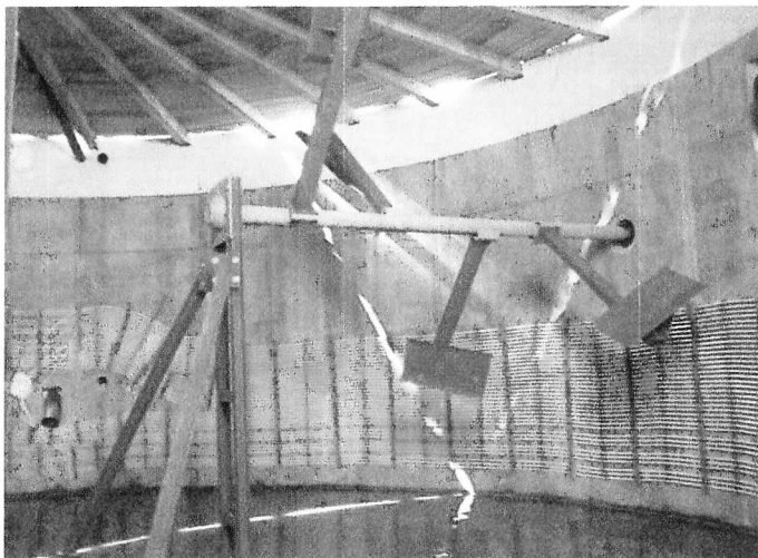
Widok mieszadła masy fermentacyjnej Padelgigant® przeznaczonego dla biogazowni rolniczych Źródło: www.agrikomp.pl
